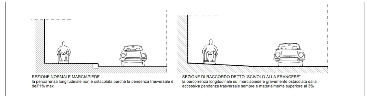
FIGURA 5 PENDENZA TRASVERSALE MASSIMA AMMISSIBILE MARCIAPIEDE
