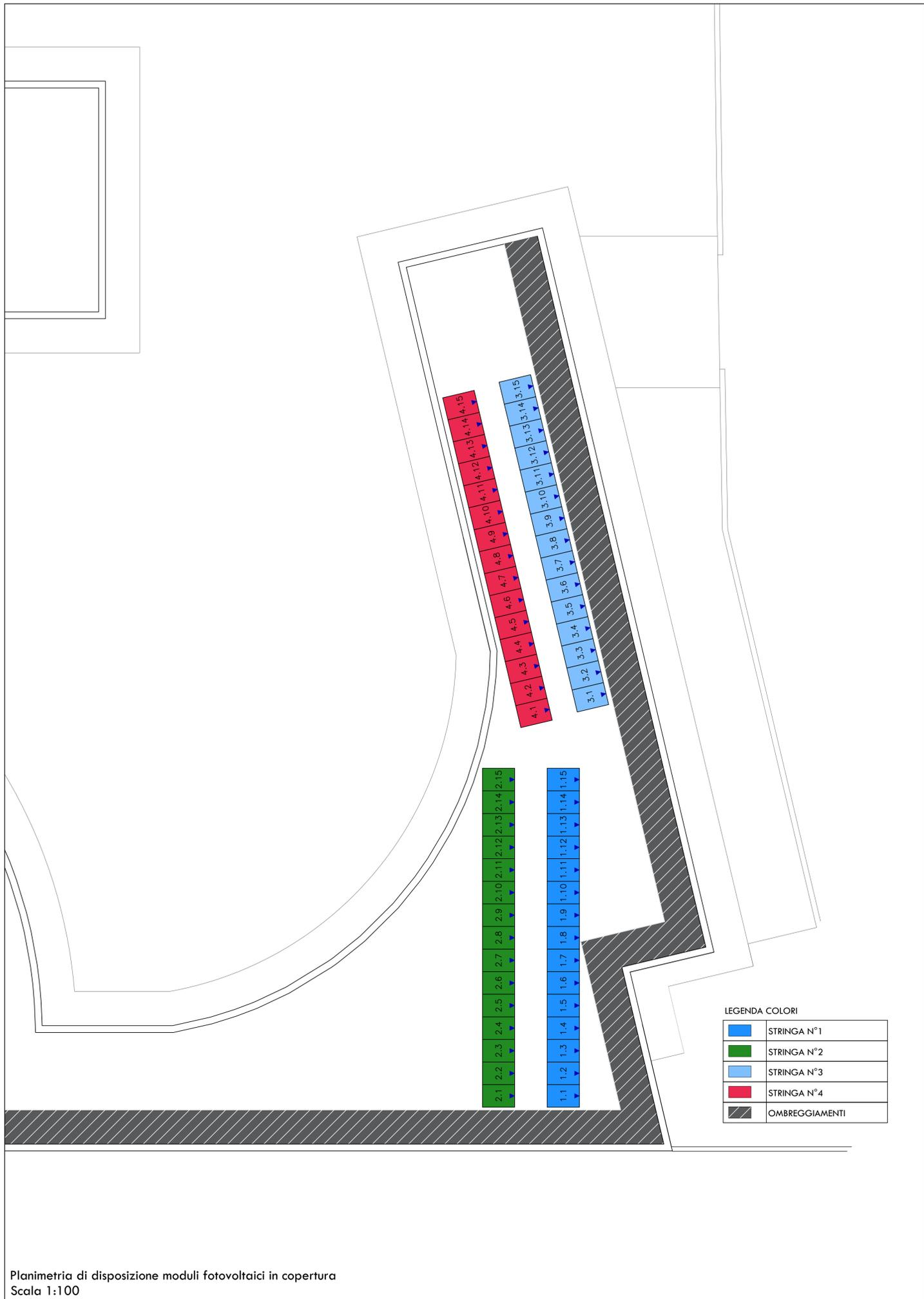
Planimetria di disposizione moduli fotovoltaici in copertura
