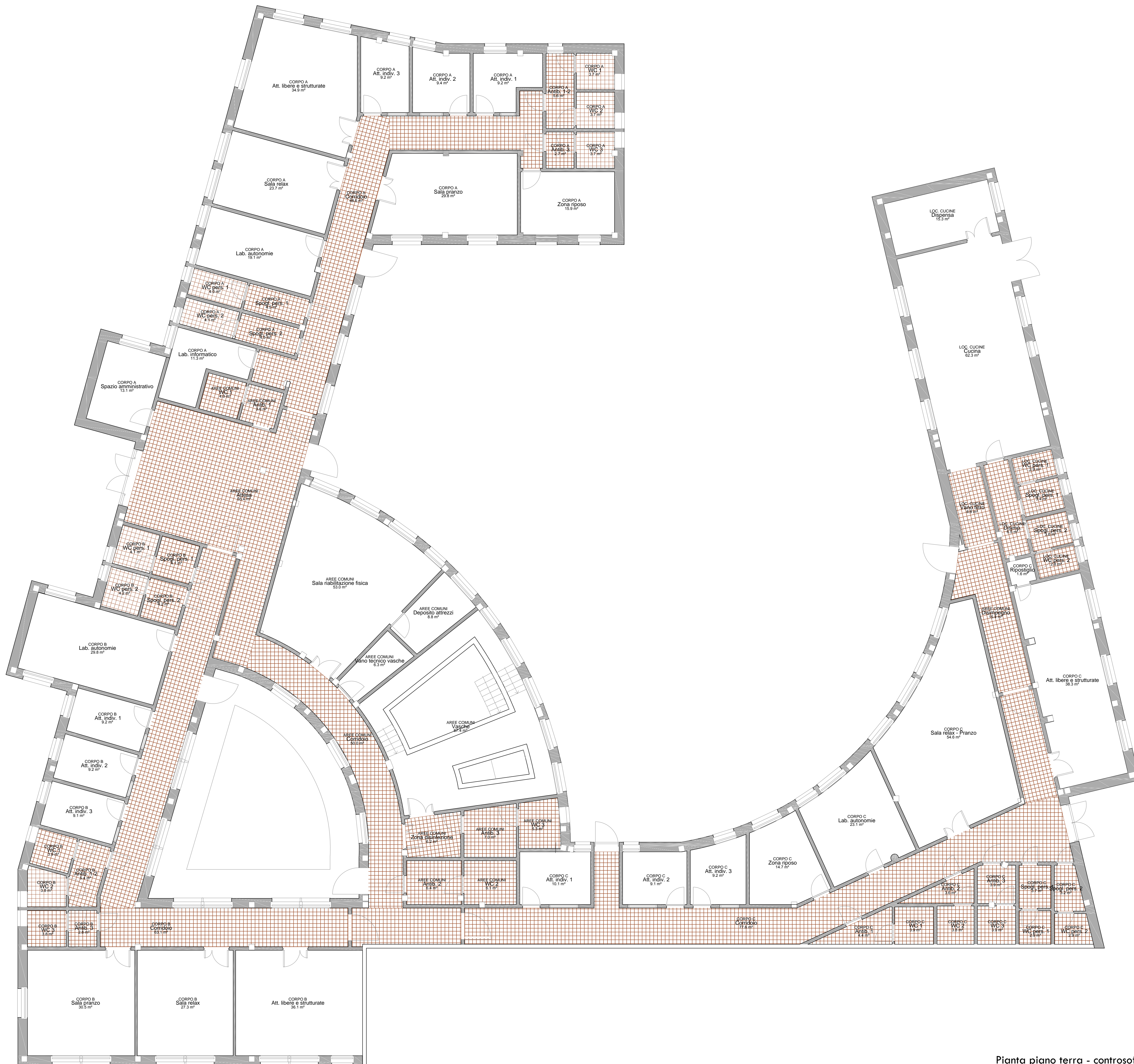
Pianta piano terra - controsoffitti scala 1:100
