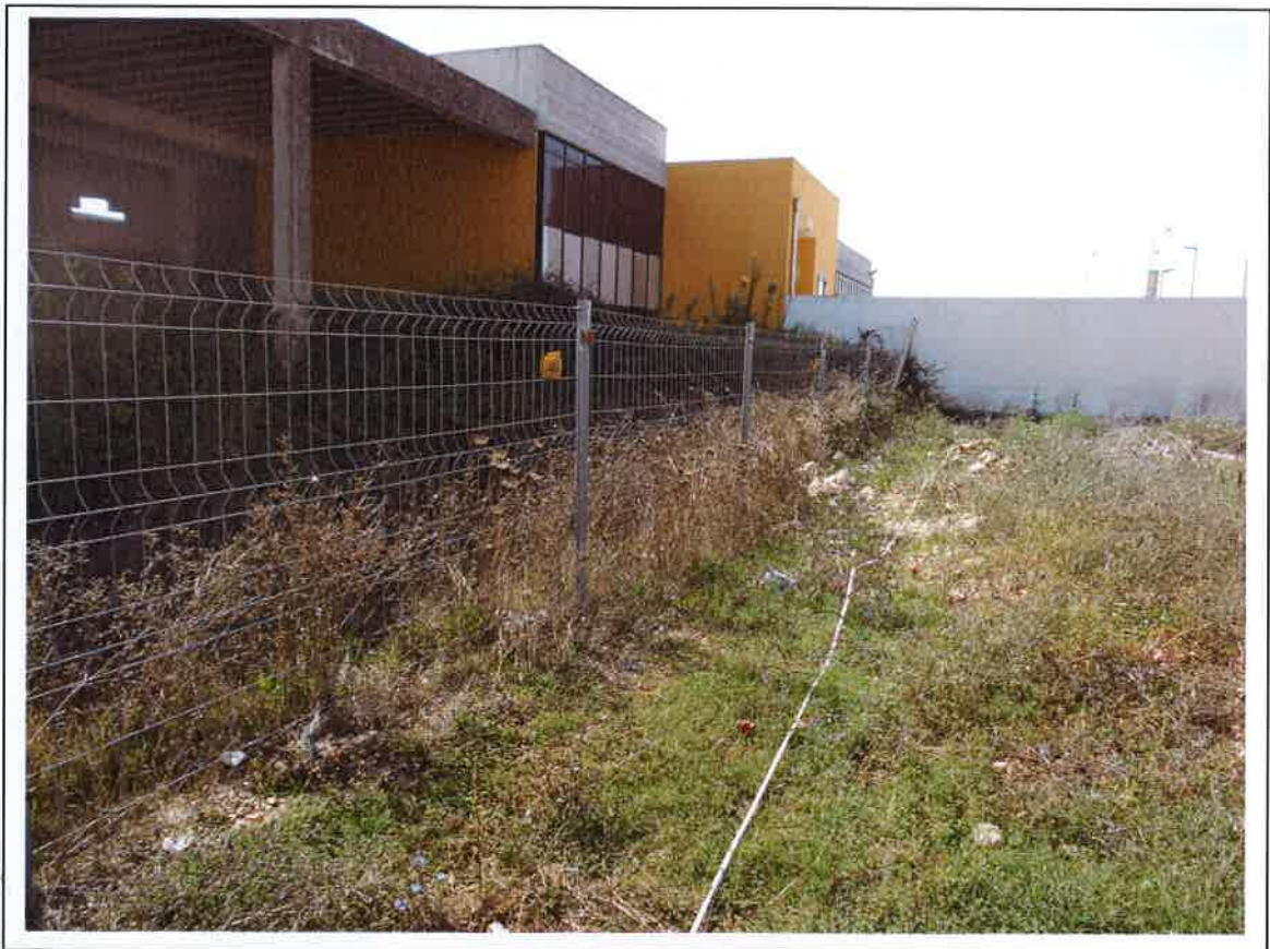
Esecuzione profilo sismico a rifrazione e sismica ReMi sullo stesso stendimento
